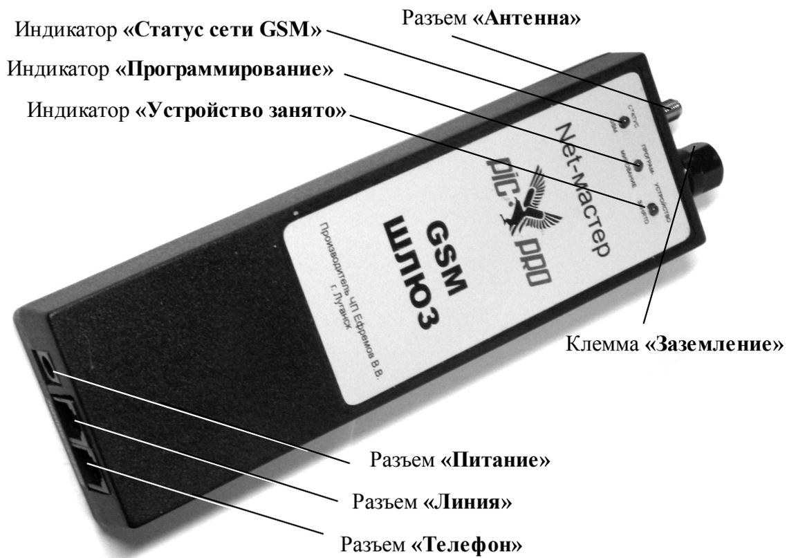
Рис. 1 — Внешний вид устройства
